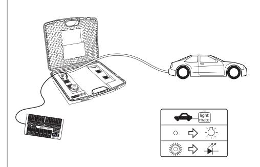
Simulation de charge de lampe pour contrôler le bon fonctionnement de la prise et éventuellement du système électronique
