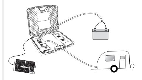
En utilisant une batterie externe de 12 V, il est possible de tester les fonctions d'éclairage de la remorque.
